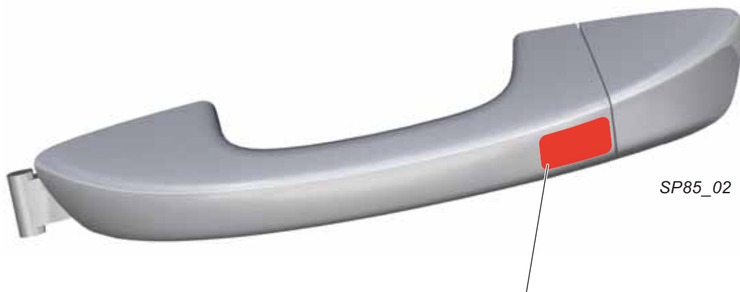
Fläche des kapazitiven Sensors zum Verriegeln des Fahrzeugs
